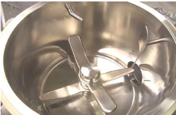
Werkzeug, Materialspurer, Lanze für Flüssigkeitszugabe
