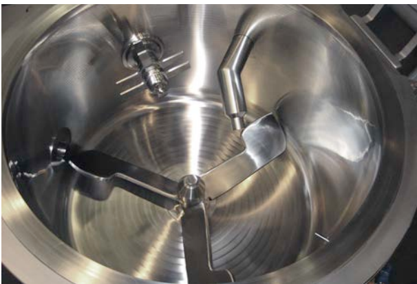
Mischerinnenraum mit Messerkopf und Sprühsystem
